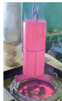
Рис. 11. Защитные втулки насосов обработанные по технологии «Карбо-бор»
