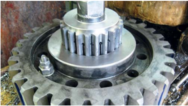
Рис. 3. Крупномодульные шестерни после цементации по технологическому режиму рис. 1
