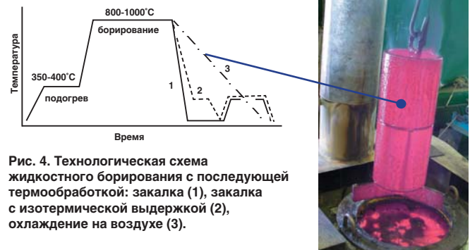
Рис. 4. Технологическая схема жидкостного борирования с последующей термообработкой: закалка (1), закалка с изотермической выдержкой (2), охлаждение на воздухе (3).
