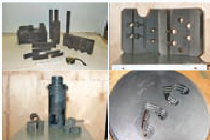
Рис. 13. Примеры применения оксикарбонитрации при изготовлении штамповой оснастки и прессформ
